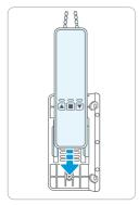
Asegúrate de que exista la tensión adecuada entre el motor y la cadena de la cortina para que el mecanismo pueda operar correctamente.
