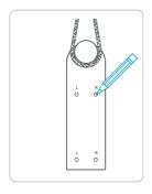
2 Una vez teniendo los orificios en la pared, remueve la guía de instalación y toma la placa para instalar el motor. Coloca y fija las pijas a la pared.
